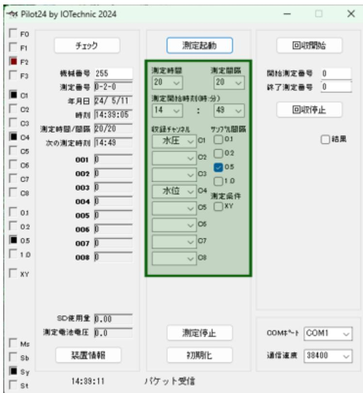
7. 本体から、エコーパケットを受信し、**[F2]** を表示します。**[本体状態情報]** と **[状態インジケータ]** を確認して下さい。待機状態 **[Sy]**、ONを確認します (右図)。最初の待機状態から、最初の予備測定開始までは、**動作確認ランプ** が2秒間隔で点滅し、測定起動を知らせます。
