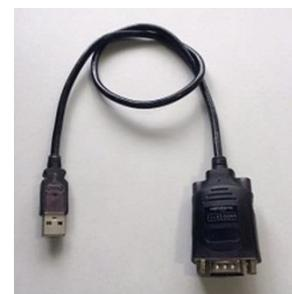
Photo.21 USB-RS232C 変換ケーブル(バッファロー社制: BSUSRC06)
