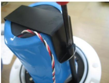
Photo.7 バッテリー固定板をドライバーで取り外します
