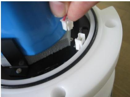
Photo.10 バッテリーパックとバッテリーコネクタの装着
