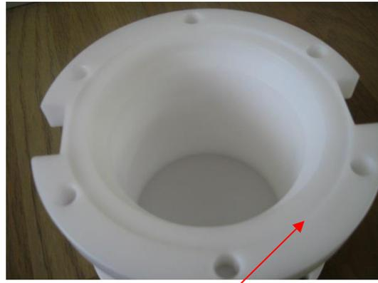
Photo.23 Oリングが接する面(耐圧タンク側)
