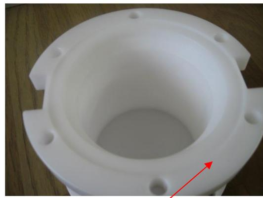
Photo.6 Oリングが接する面(耐圧タンク側)
