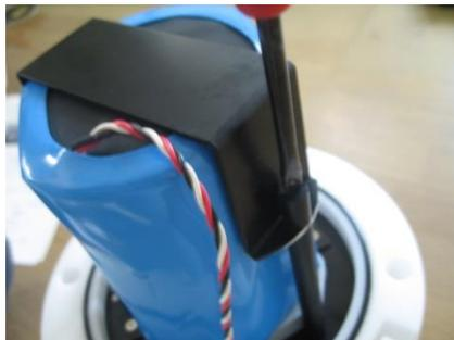
Photo.11 バッテリー固定板のボルトを締めます
