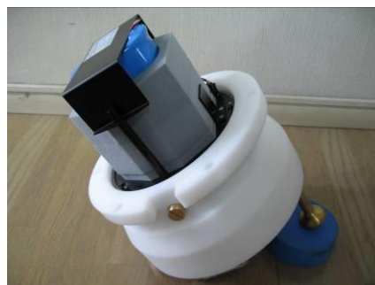
Photo.4 電磁流速センサーの下にスポンジを敷き本体を固定する
