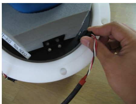
Photo.20 パソコン接続ケーブルを接続する
