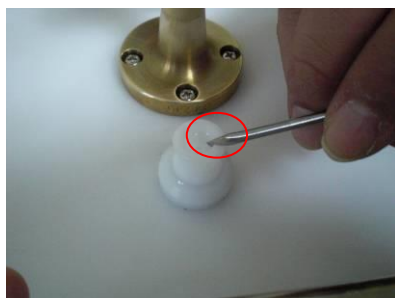
Photo.5 溝の部分を小型マイナスドライバーで付着物や砂などを取り除きます
