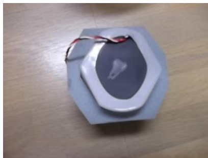
Photo.8 バッテリー保護スポンジに バッテリーパックを挿入
