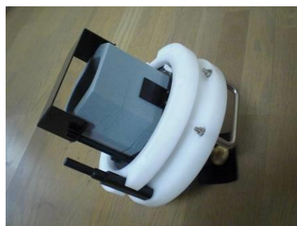
Photo.4 電磁流速センサーの下にスポンジを敷き本体を固定する
