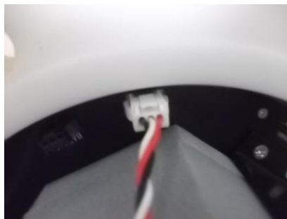
Photo.11 バッテリーコネクター装着後
