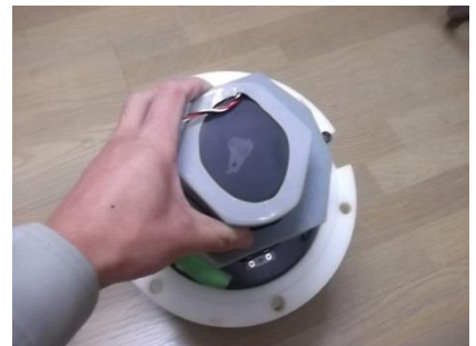
Photo.9 バッテリー保護スポンジお よびバッテリーパックを収納部分に 置きます。
