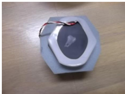
Photo.8 バッテリー保護スポンジに バッテリーパックを挿入
