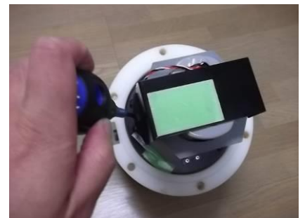
Photo.12 バッテリー固定板のボルト を締めます。
