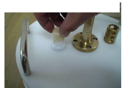
Photo.7 カチッとツメが掛かるまで押し、キャップを被せます
