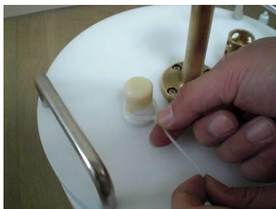
Photo.8 結束バンドでツメの部分 締め付けます
