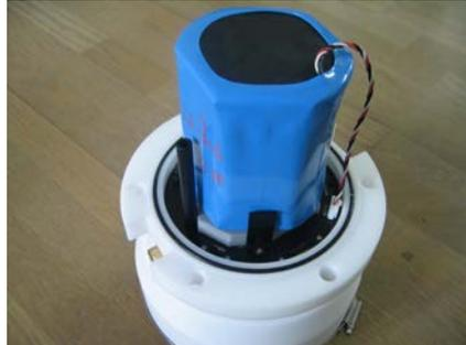
Photo.13 バッテリー固定板取り外し後
