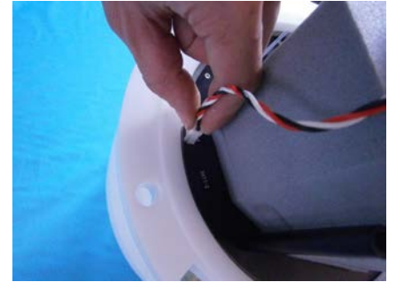
Photo.14 バッテリーコネクタ取外し
