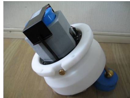
Photo.4 スポンジに電磁流速センサーを乗せ固定する。
