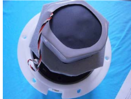
Photo.13 バッテリー固定板取り外し後
