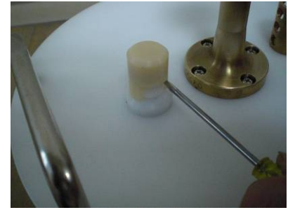
Photo.3 キャップ横の溝に小型マイナスドライバーを入れねじ込んで外します
