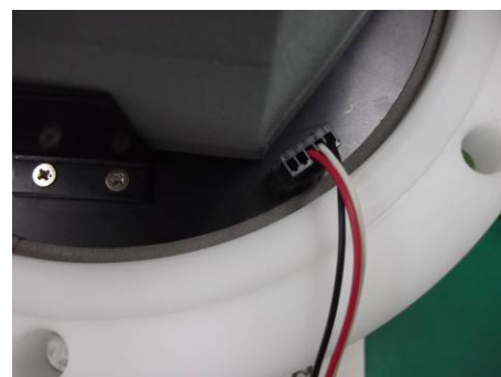
Photo.18 パソコン接続ケーブルを 接続する
