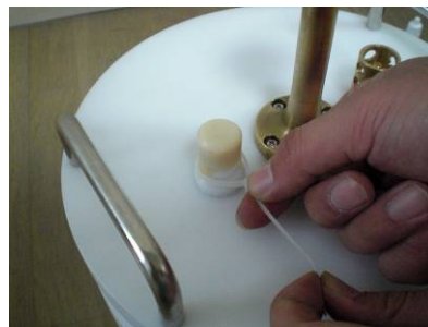
Photo.8 インシュロックでツメの部分を締め付けてください。
