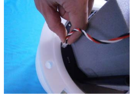
Photo.14 バッテリーコネクタ取外し
