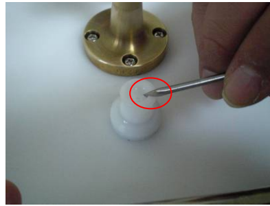
Photo.5 溝の部分を小型マイナスドライバーで付着物や砂などを取り除いてください
