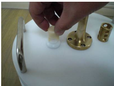
Photo.7 カチッとツメが掛かるまで押し、キャップを被せてください。
