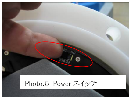
Photo.5 Power スイッチ
