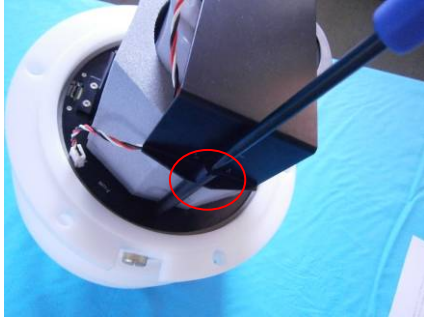
Photo.12 バッテリー固定板取り外し
