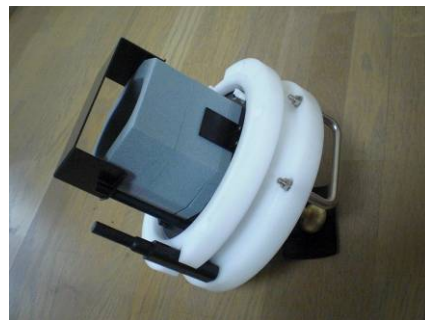
Photo.4 片側のハンドルを下に向けて電磁流速センサーの下にゴムを置き保護する。
