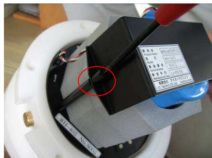
Photo.8 バッテリー固定板取り外し
