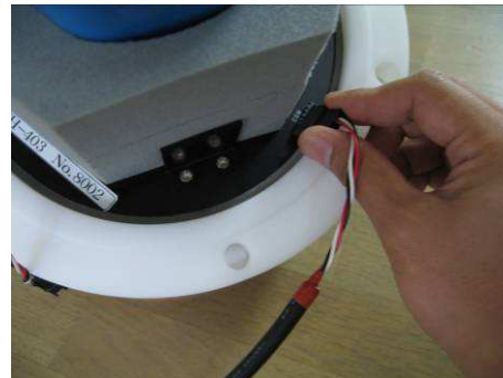
Photo.14 パソコン接続ケーブルを 接続する
