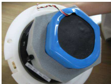
Photo.9 バッテリー固定板取り外し後
