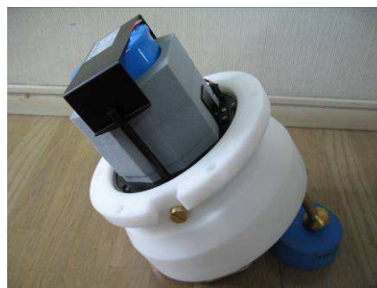
Photo.4 スポンジに電磁流速センサーを乗せ固定する。
