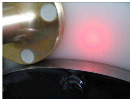
Photo.6 動作確認ランプ
