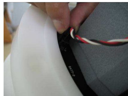
Photo.10 バッテリーコネクタ取外し
