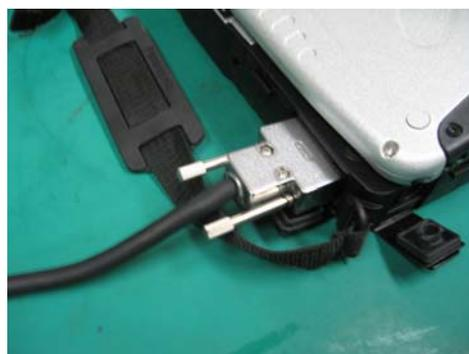
Photo.4 反対側Dサブ9ピン側をパソコンのシリアルポートに装着し各制御を行ってください
