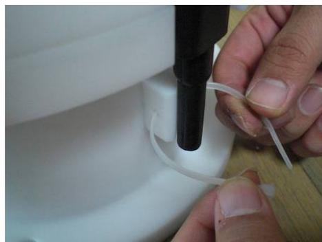
Photo.2 水中コネクタ固定板の穴を使用してインシュロックを挿入する
