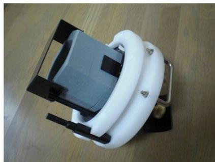
Photo.4 片側のハンドルを下に向けに電磁流速センサーの下にゴムを置き保護する。
