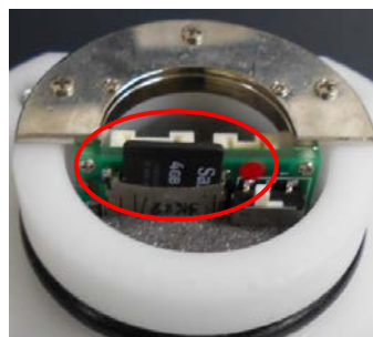
Photo.2 [SDカード]取外し状態
