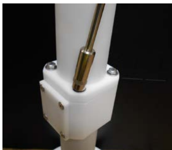
Photo.1 M5ボルトの取外し
