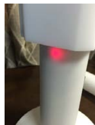
Photo.1 [動作確認ランプ]の点
