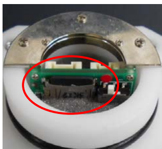
Photo.1 [SDカード]取付け状態
