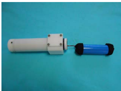
Photo.1 [リチウムバッテリー]の取付け
