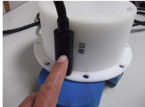
Photo.17 通信ケーブル装着
