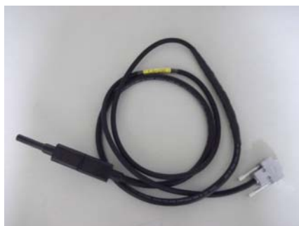
(Photo.5) 通信ケーブル
