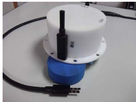
Photo.24 ダミーコネクタ取り付け状況
