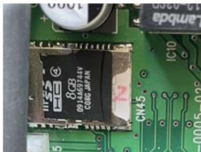
Photo3.5 SDカード取付け状態
