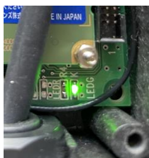
Photo3.9 動作確認ランプの点灯状態
