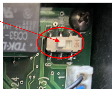
Photo3.8 パワーオン状態
