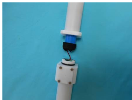
Photo3.2 リチウムバッテリーの接続状態
