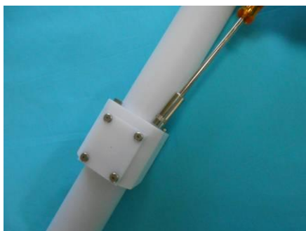
Photo3.1 六角ボルトの取り外し
