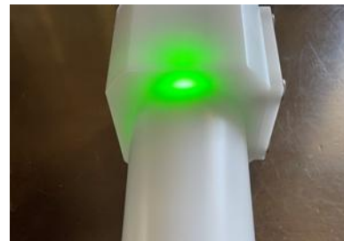
Photo4.2 動作確認ランプ点灯
