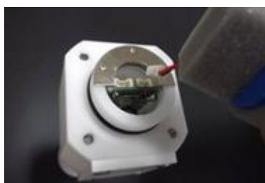
Photo3.6 リチウムバッテリーの取付け
