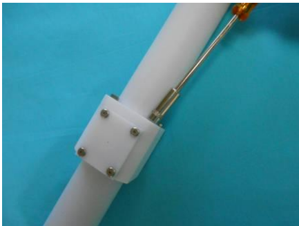
Photo3.1 六角ボルトの取り外し
