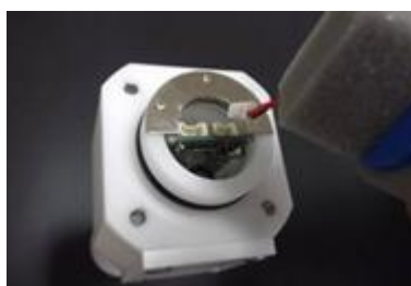
Photo3.6 リチウムバッテリーの取付け
