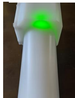
Photo3.14 動作確認ランプの点灯状態(装置外部)
