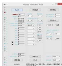
⑤ 正しく接続されていれば、「チェック」を押すと、装置の状態情報が表示されます。以上で通信の準備が整いました。
