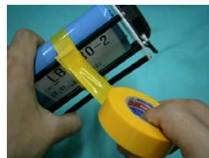
③ バッテリーを固定します。ビニールテープを推奨しますが、固定が出来れば何でも構いません。蓋を閉じる時に支障が無いように注意します。
