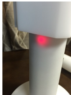
Photo.5 [動作確認ランプ]の点灯状態(装置外部)
