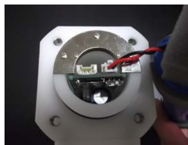
Photo.5[リチウムバッテリー]の取付状態確認
